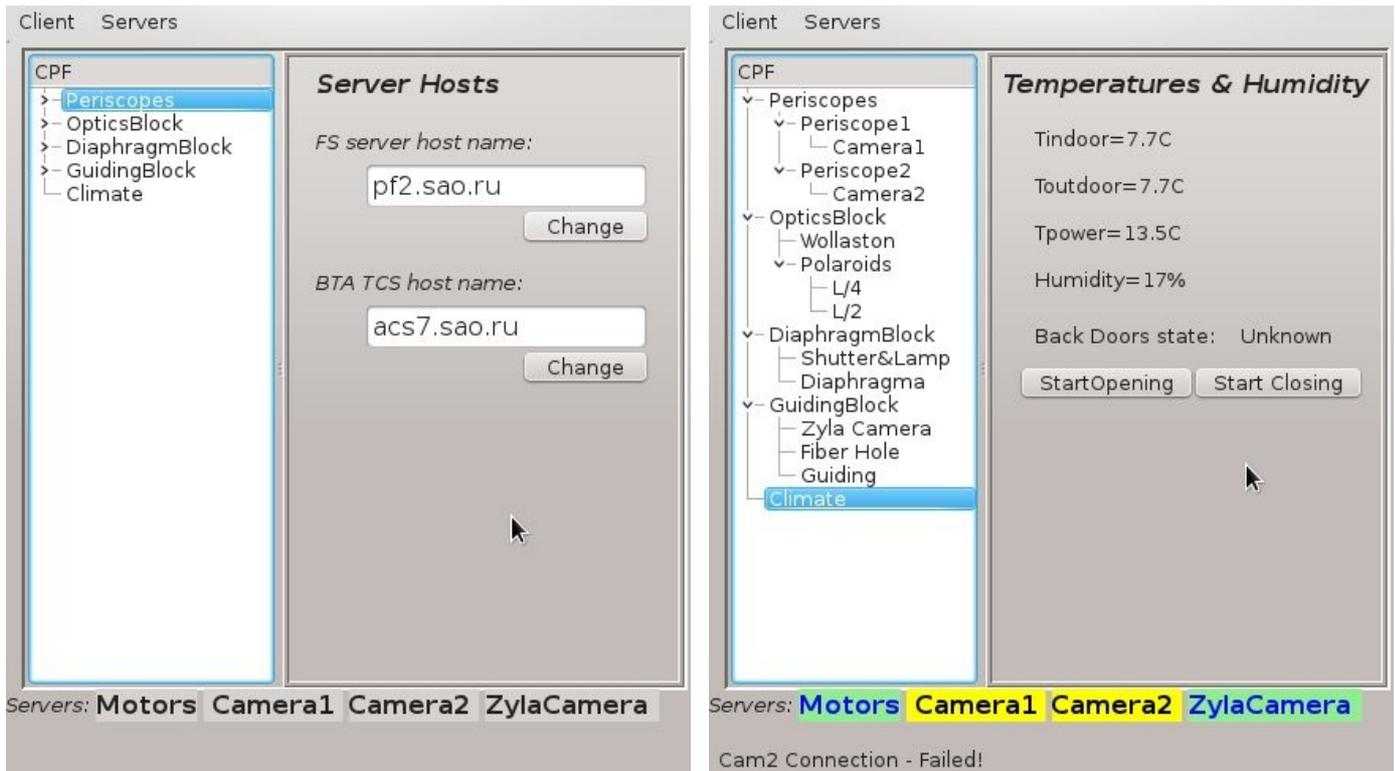
Основные управляющие и информационные функции собраны в панели, которые переключаются с помощью дерева выбора. Дополнительные окна (например TV-камер гидрирования) включаются из этих панелей по мере необходимости. Внизу главного окна индикация связи с серверами в главном управляющем компьютере прибора. Зелёный цвет - связь работает, жёлтый - связи нет.
