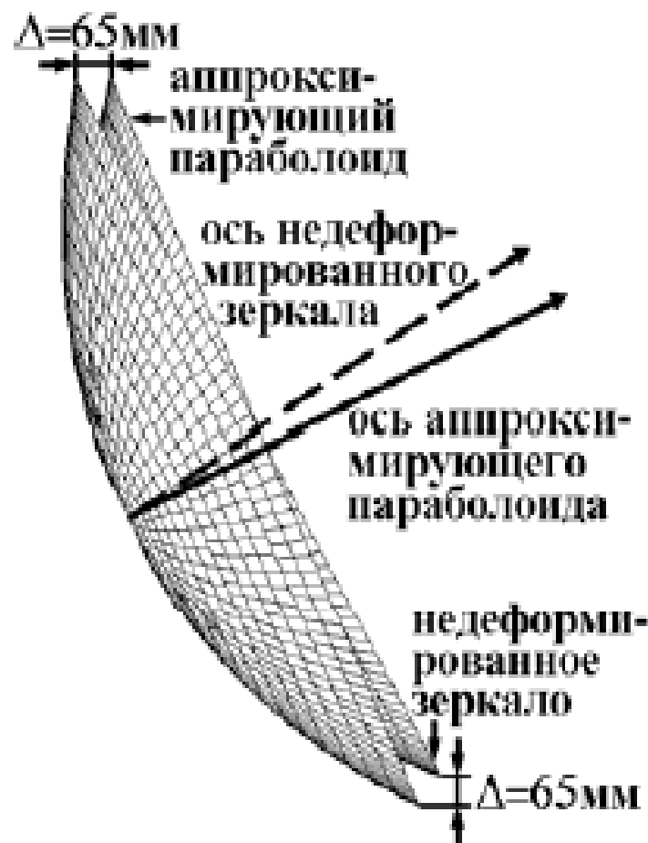
Сравнение недеформированного зеркала и аппроксимирующего параболоида (увеличено в 40 раз)
