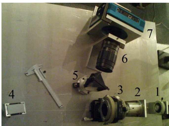
Рис.Б.2 - Макет эшелле-спектрографа с интерферометром на внутренней установке. Обозначения: 1 - оптоволоконный вход, 2 - линзовый коллиматор, 3 - интерферометр, 4 - решетка эшелле, 5 - призма скрещенной дисперсии, 6 – линзовая камера, 7 – светоприемник.
