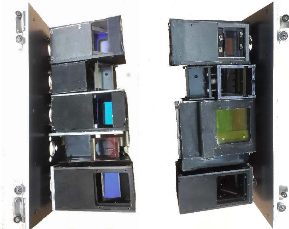
**Рис. 7.** «Этажерка» с цветоделительными модулями. Слева вид со стороны «синего» канала. Модули снизу вверх: «прозрачный», EMCCD-камера, фотометрический, призма Аббе, спектральная решетка. Справа — со стороны «красного».
