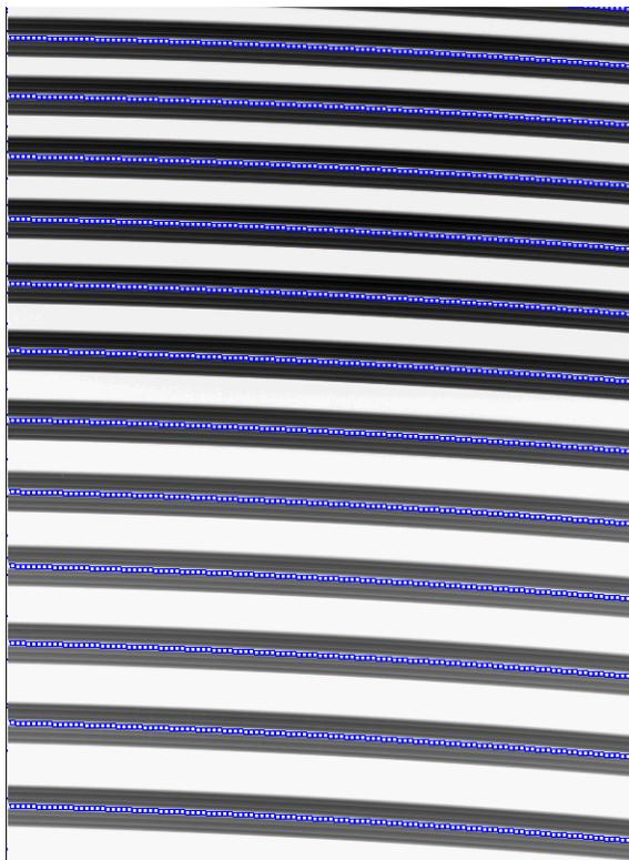
**Рис. 2.** Пример определения центров эшелле-порядков процедурой, настроенной на параметры спектрографа HRS. Приведена небольшая часть двумерного спектра лампы плоского поля. Найденные позиции центров эшелле-порядков показаны квадратиками. Видна сложная структура каждого порядка.
