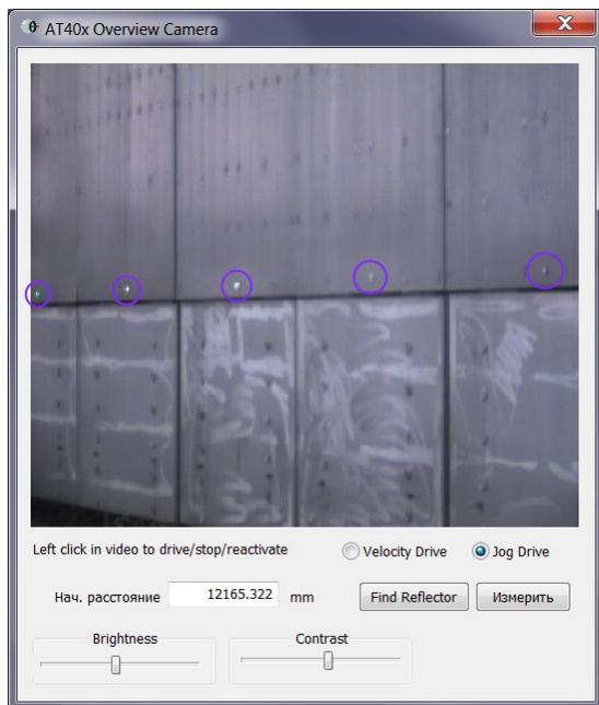
Рис. 1. Размещение сферических полудюймовых отражателей.
